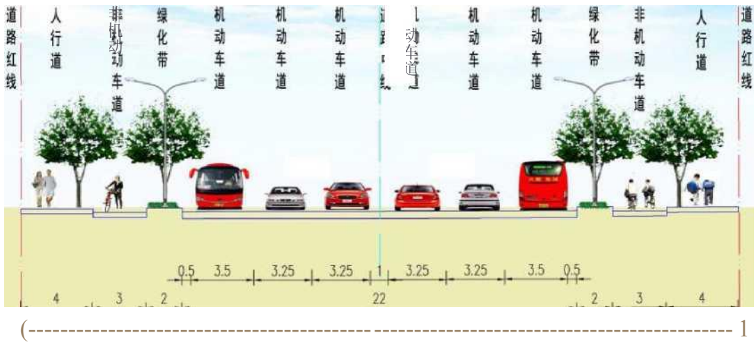
图 5 翔安路、翔升路、翔泰路断面示意图
